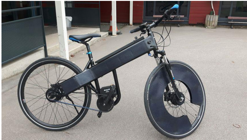
Des cellules photovoltaïques sur le cadre et la roue avant permettent de recharger ce vélo électrique grâce au soleil © Radio France - Emilie Defay
