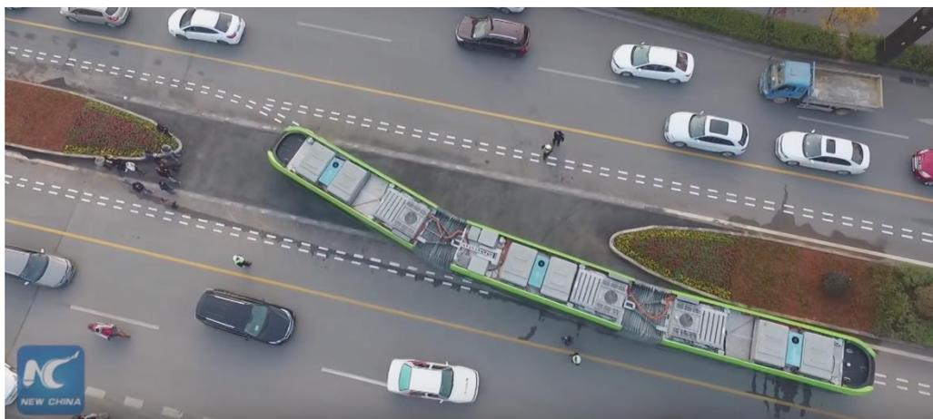
Le marquage au sol permettant à ART de naviguer de manière autonome en phase de test.
