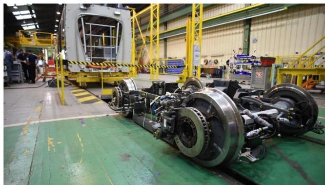
Les 4 roues du bogie motorisé sont équipées d'un **moteur électrique asynchrone**. Tous les moteurs d'une rame sont indépendants, ils sont commandés et régulés électroniquement. Ces machines peuvent également fonctionner en **générateur d'énergie électrique** ce qui a pour conséquence de les freiner [freinage dynamique].
