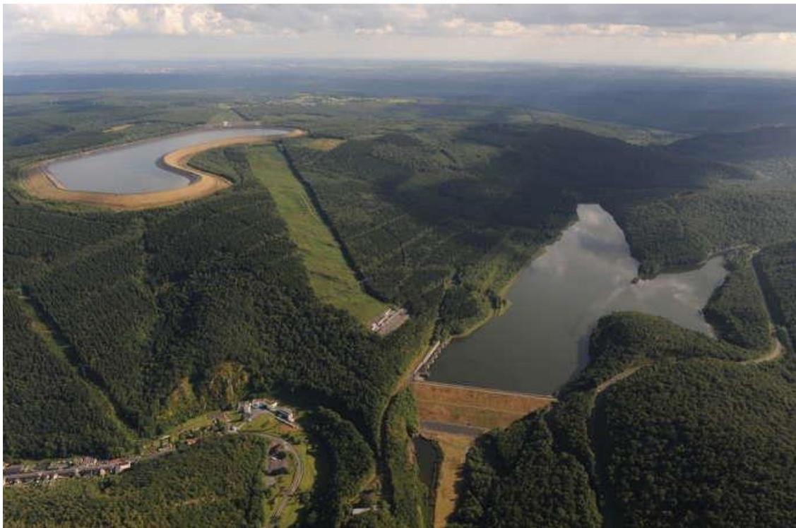
La station de transfert d'énergie par pompage (STEP) de Revin, dans les Ardennes, est alimentée par deux réservoirs de 7 millions de m<sup>3</sup> d'eau, séparés par un dénivelé de 230 mètres. L'eau du bassin inférieur est pompée aux heures de faible consommation d'électricité vers le bassin supérieur, pour être relâchée aux heures de pointe vers le bassin inférieur, en actionnant des turbines. ©EDF
