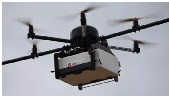
Le drone de La Poste de DPDgroup peut porter jusqu'à 3 kg sur une distance de 14km. ©BORIS HORVAT/AFP
