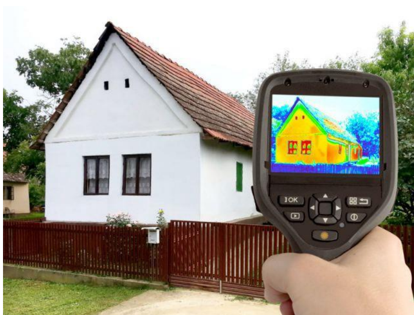
Une caméra thermique mesure les déperditions de chaleur © Suljo - Thinkstock
