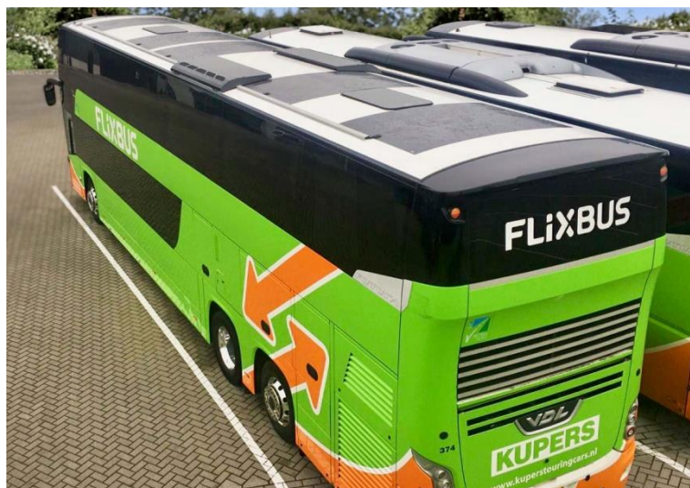
Car double étage équipé de panneaux solaires © FlixBus
