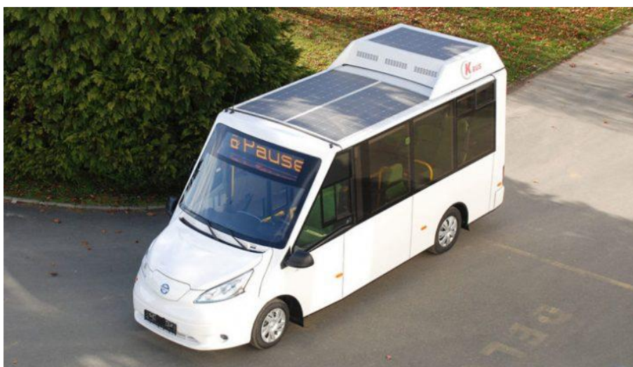
Nissan e-NV200 transformé en bus électrique avec toit solaire © K-Bus
